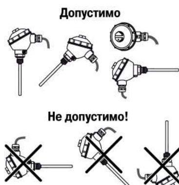
Рисунок 5.2 – Положение при монтаже
